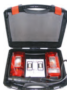
Maletín para comprobar el funcionamiento de la instalación eléctrica para remolque realizada en el vehículo
